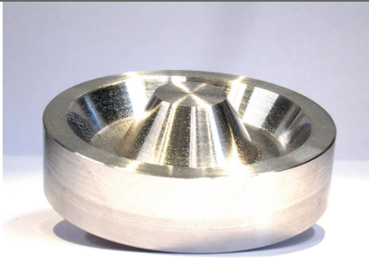
Widerstandsfähig: Der gedruckte Stelitkörper als Teil des hybriden Schmiedewerkzeugs © FGW
