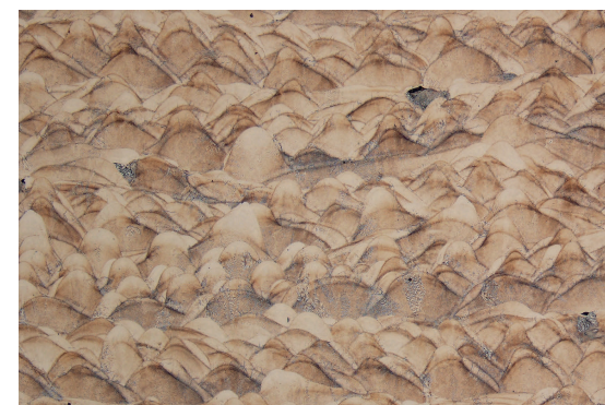
Gleichmäßig: Das 3D-gedruckte Celsit 21, geätzt mit erkennbaren Schweißspuren, weist einen gleichmäßigen, homogenen Gefügeaufbau auf © FGW
